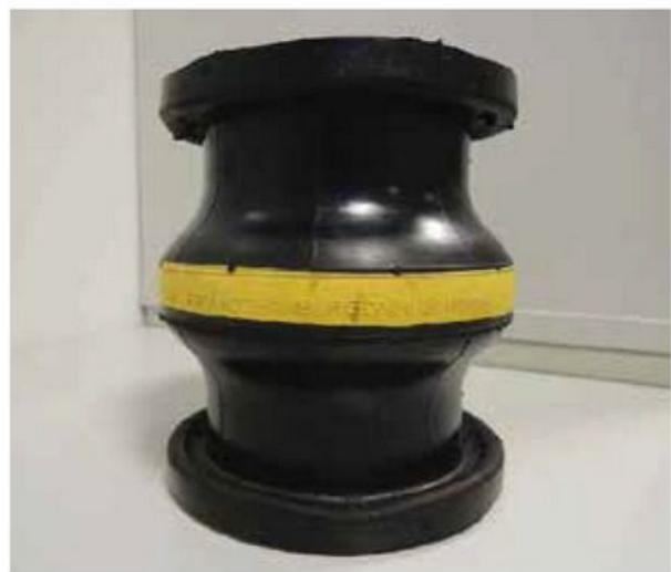
Маркировка без надписи "ERV" и ромба Elaflex, на цветовой полосе, размещенной вокруг компенсатора
